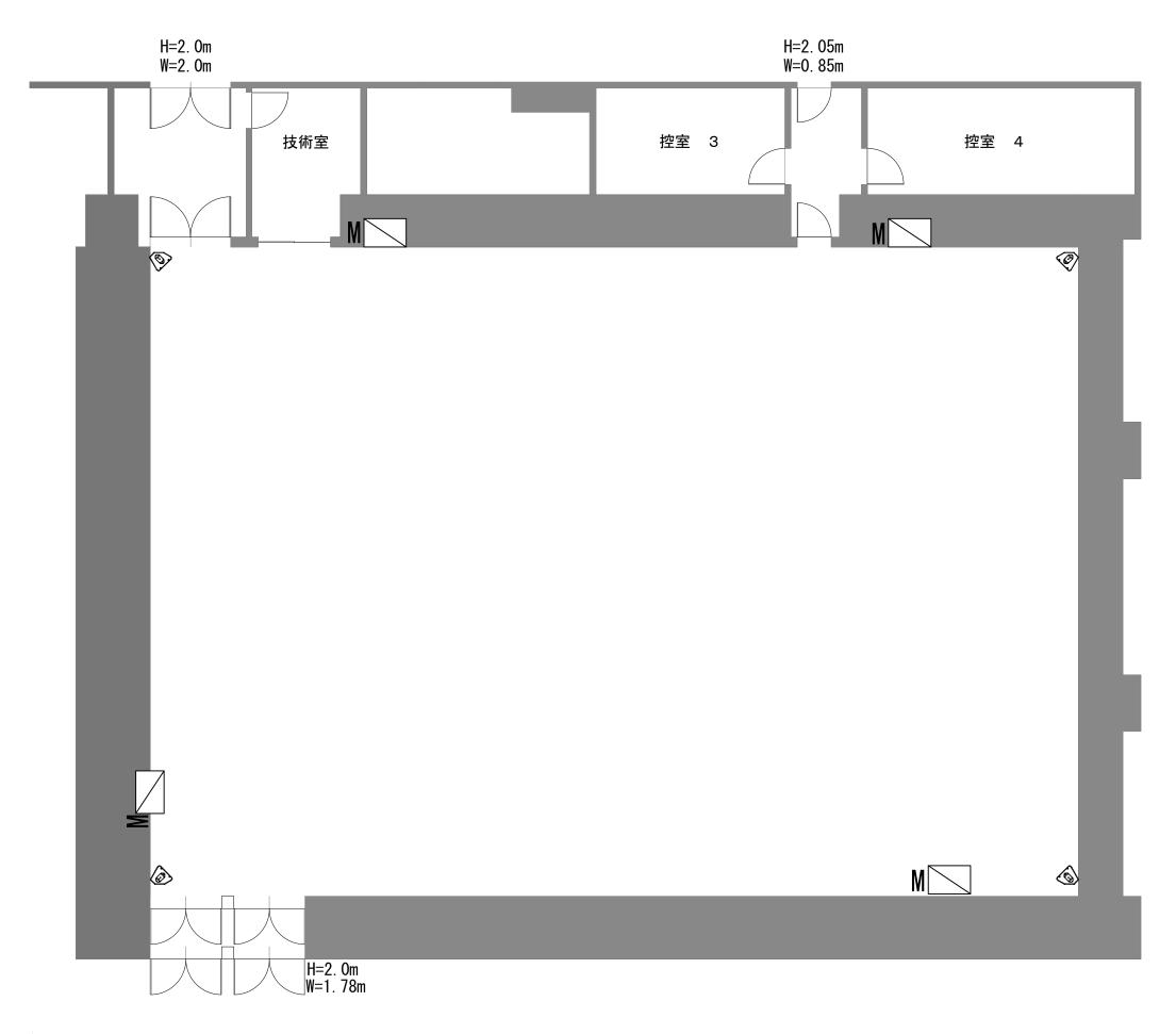
総合コンセント盤 マイクコンセント×8 スピーカーコンセント×4 音響用電源AC100V(15A)
