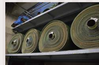
巻いて収納された人工芝。芝が縮まないよう、冬場は暖房をつけたままの状態を保管されている。芝を清掃する専用の車両も。
