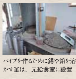
パイプを作るために錫や鉛を溶かす釜は、元給食室に設置
