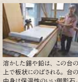
溶かした錫や鉛は、この台の上で板状にのべられる。台の中身は保温性のいい御影石。そこから下がっている布は消防士の防火服と同じ素材
