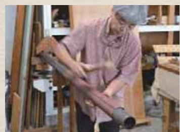
かんなどで削って慎重に厚みを整えた板を筒状に加工、大小さまざまなパイプが作られる
